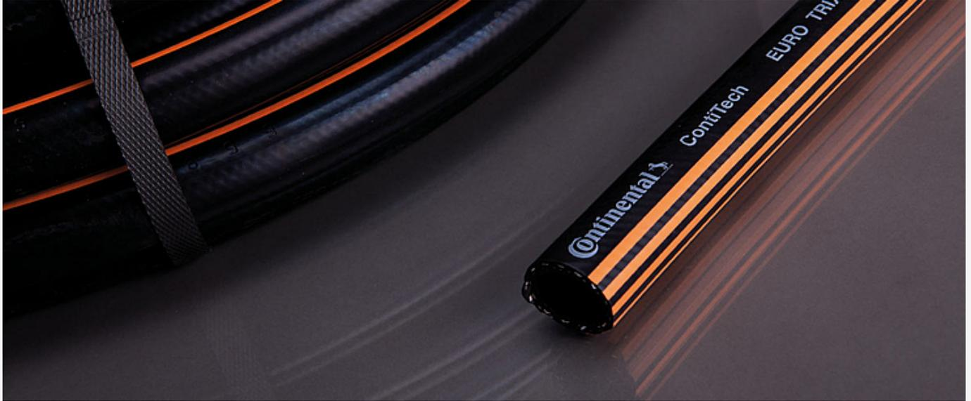
Euro Trix® ist ein EPDM Gummischlauch mit schwarzer, porenfreier, glatter EPDM-Innen- und Außenschicht. Außenschicht mit orangen Streifen. Der Druckträger ist synthetisches Garn.
