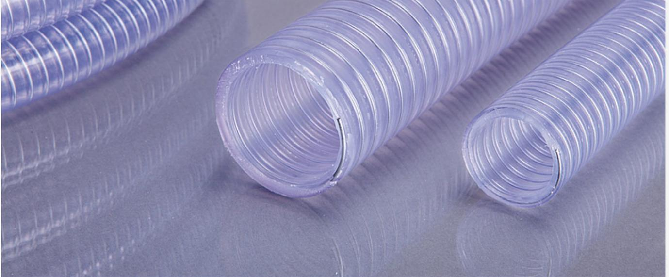
Flexibler Saugschlauch aus Weich-PVC verstärkt mit einer Federstahlspirale, innen und außen glatt. Freigegeben für Lebensmittel entsprechend der europäischen Richtlinie EU 10/2011 A, B und C.
